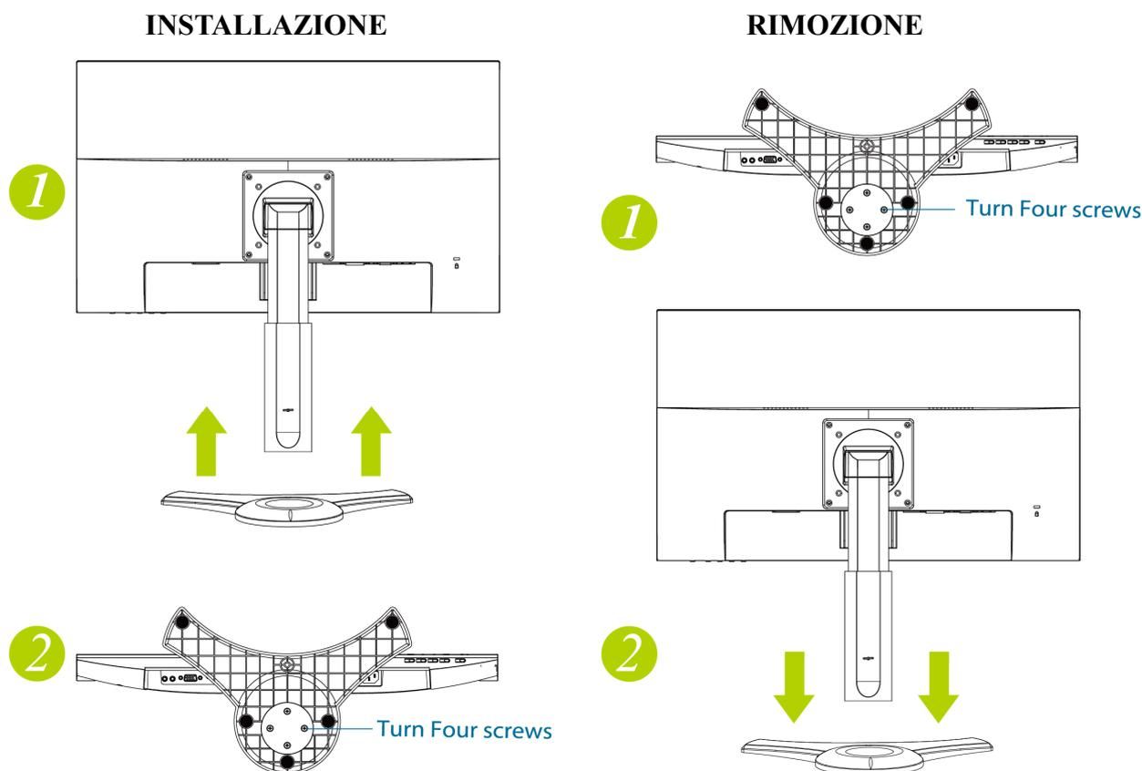
Figura.1. Installazione e Rimozione della Base
